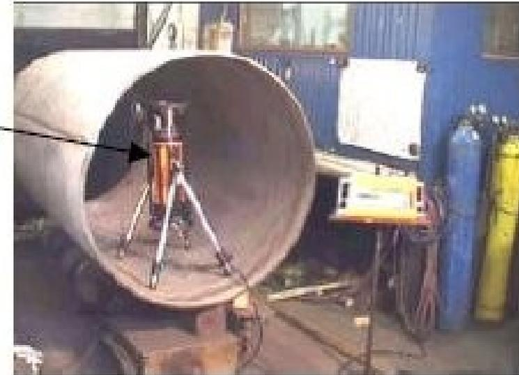
Inspeção radiográfica de soldas em tubos
